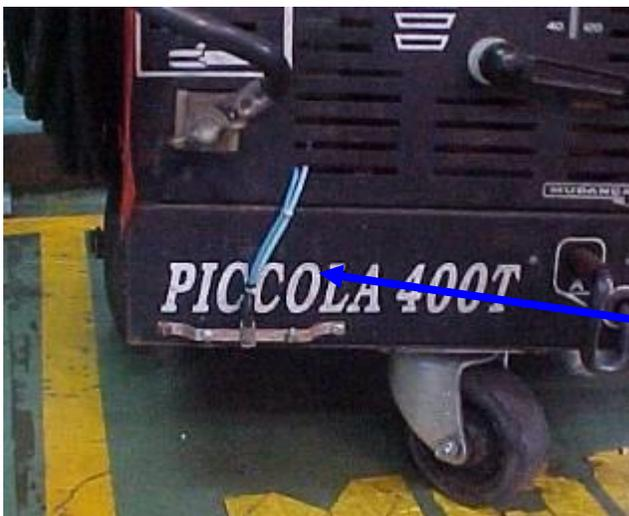
**O cabo terra saindo da máquina de solda e fixada na carcaça da máquina de solda.**
